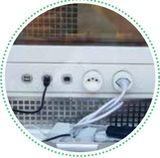
Platine de service avec prise électrique, prise USB et raccord Tri-Clamp pour le raccordement d'un compteur de particule
