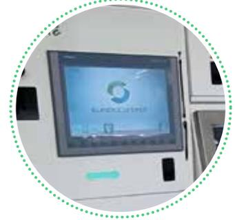
Ecran tactile couleur de 12 pouces doté d'une interface utilisateur intuitive qui facilite la navigation, l'utilisation et la surveillance des paramètres
