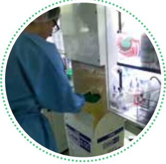
Gestion sûre et efficace des déchets : Porte RTP de nouvelle génération avec grande ouverture rectangulaire. Connexion facilitée sans rotation.
